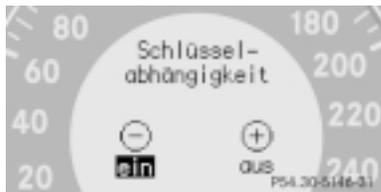
Przyciskiem **+** lub **-** można włączać (**ein**) i wyłączać (**aus**) funkcję zależności ustawień od klucza.
