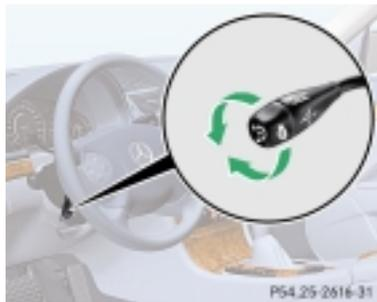
Włącznik ogrzewania kierownicy znajduje się u dołu po lewej stronie kierownicy.
