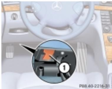
1 dźwignia odblokowania pokrywy komory silnika
