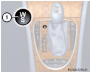
**1** przełącznik programów przełączania biegów
