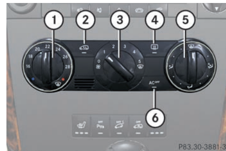
Panel obsługi układu klimatyzacji
