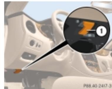
① Dźwignia odblokowująca pokrywę komory silnika
