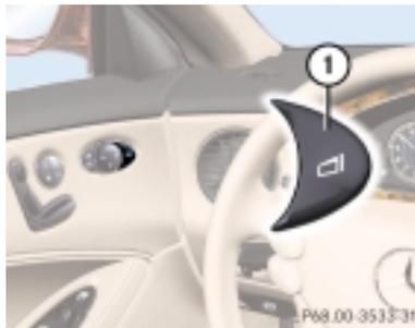
① Składanie/rozkładanie lusterek zewnętrznych
