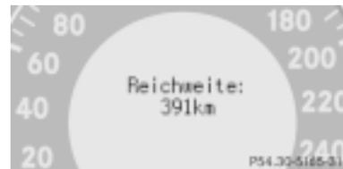
Na wyświetlaczu widoczny jest orientacyjny zasięg wynikający z aktualnej ilości paliwa w zbiorniku.
