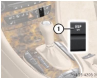
① Włączenie /wyłączenie układu ESP
