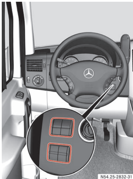
Panel przełączników między kierownicą a stacyjką
