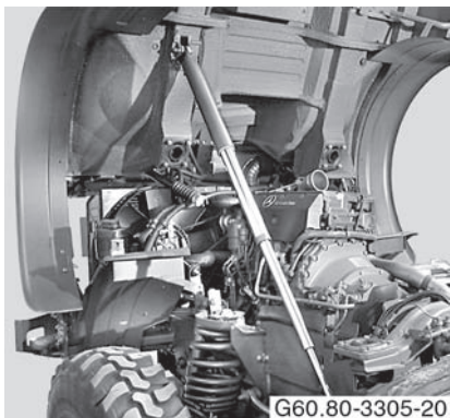
19 Kabina kierowcy przechylona.
