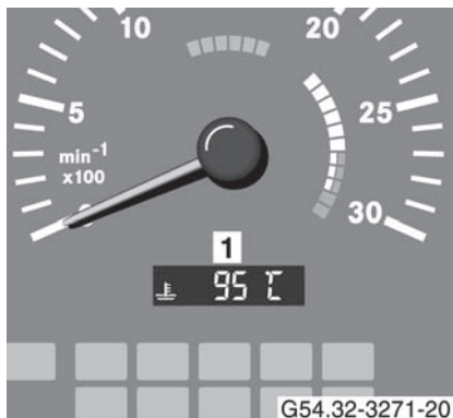
1 Wskaźnik temperatury płynu chłodzącego
