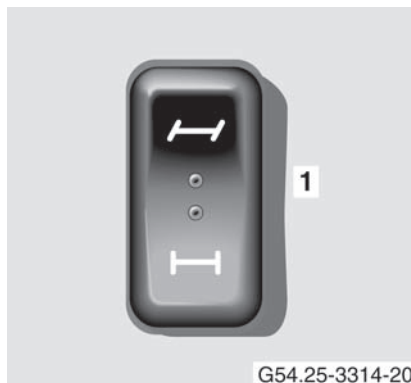
1 Przełącznik wybierania osi
