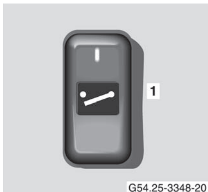
1 Wylłącznik akumulatora na tablicy przełączników (przykład)
