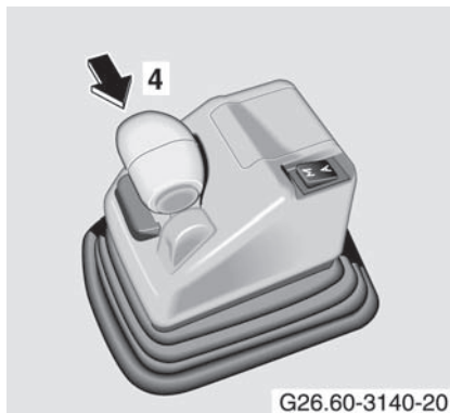
4 Przycisk położenia neutralnego
