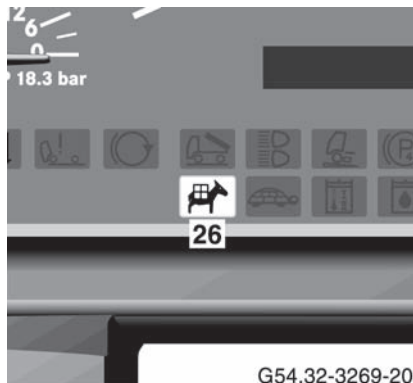
26 Lampka kontrolna biegów roboczych
