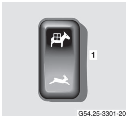
1 Przełącznik biegi robocze/drogowe
