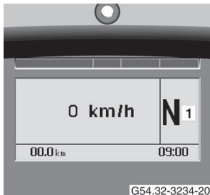
1 Wskazanie położenia neutralnego
