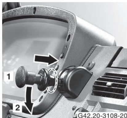
1 Zaciągnięty 2 Położenie kontrolne
