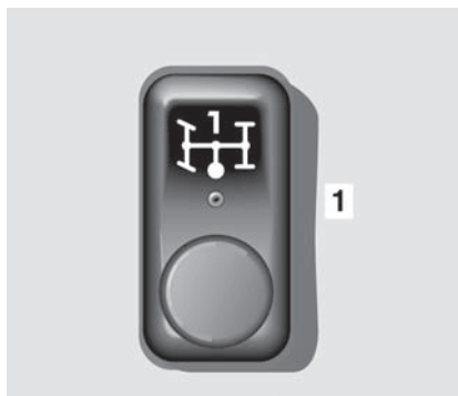
1 Przełącznik zależnej od skrzyni biegów przystawki odbioru mocy
