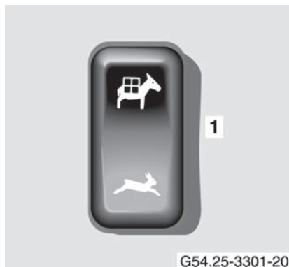
1 Przełącznik biegów robocze/drogowe
