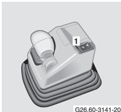
1 Przełącznik A = automatyczny tryb pracy M = manualny tryb pracy
