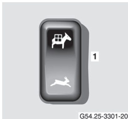
1 Przełącznik biegów robocze/drogowe
