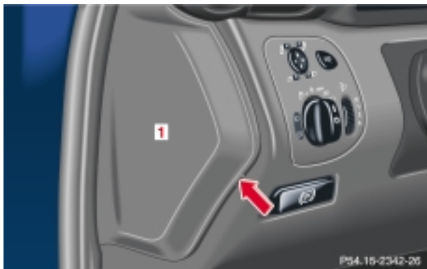
1 Skrzynka bezpiecznikowa we wnętrzu pojazdu
